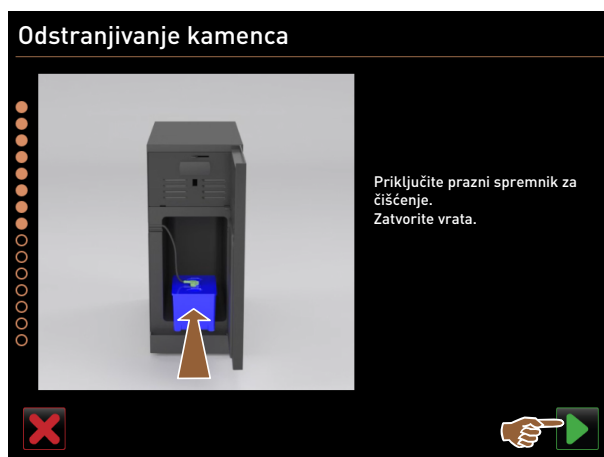
Sl. 190: Umetanje spremnika za čišćenje
