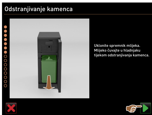
Sl. 189: Uklanjanje spremnika mlijeka
