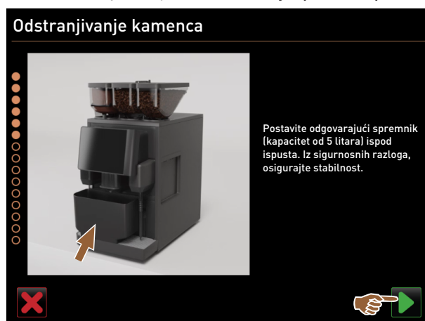
Sl. 188: Pozicioniranje posude ispod izlaza za napitke
