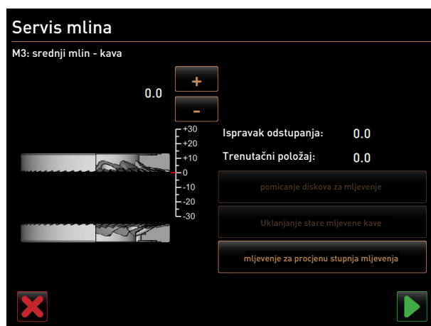
Sl. 218: Podešavanje stupnja mljevenja: mljevenje za procjenu stupnja mljevenja
