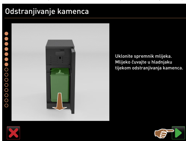
Sl. 174: Uklanjanje spremnika mlijeka
