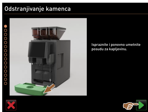
Sl. 183: Uklanjanje posude za kapljevinu
