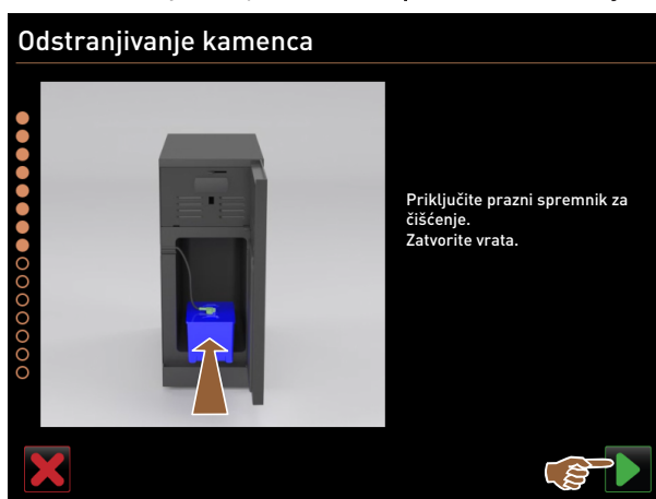
Sl. 175: Umetanje spremnika za čišćenje
