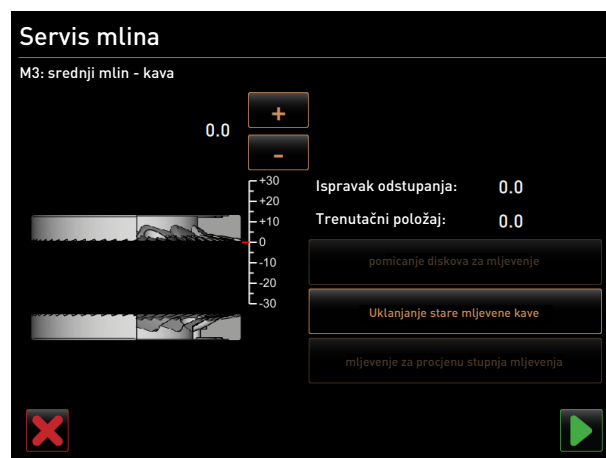
Sl. 217: Podešavanje stupnja mljevenja: uklanjanje stare mljevene kave
