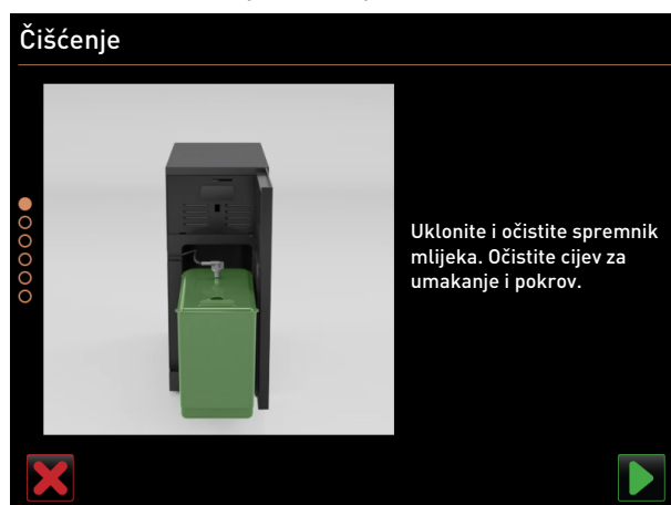
SL 112: Uklanjanje spremnika mlijeka
