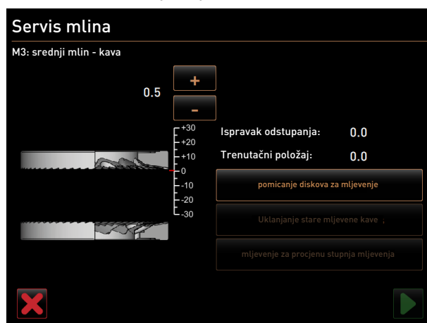
Sl. 219: Podešavanje stupnja mljevenja: pomicanje diskova za mljevenje
