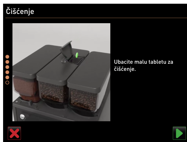
Sl. 110: Ubacivanje tablete za čišćenje
