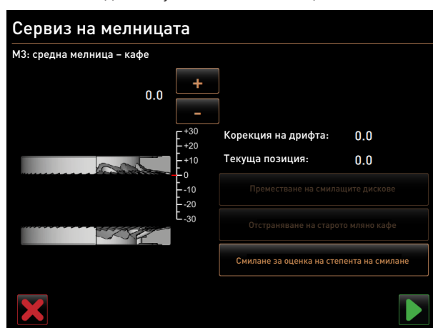
Фиг. 218: Настройка на степента на смилане: смилане за оценка на степента на смилане
