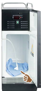
Фиг. 134: Почистване на модула за охлаждане
