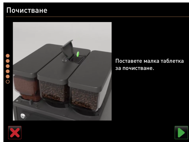
Фиг. 110: Поставяне на таблетка за почистване
