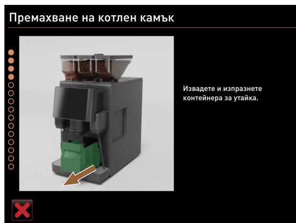
Фиг. 171: Изваждане на контейнера за утайка
