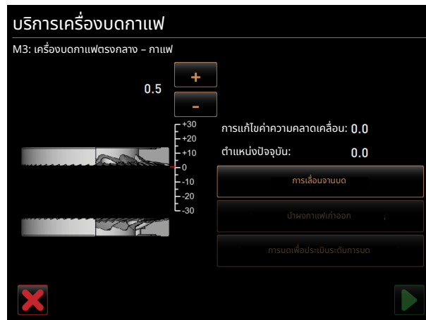
รูป 278: การตั้งค่าระดับการบด: การเลื่อนจานบด
