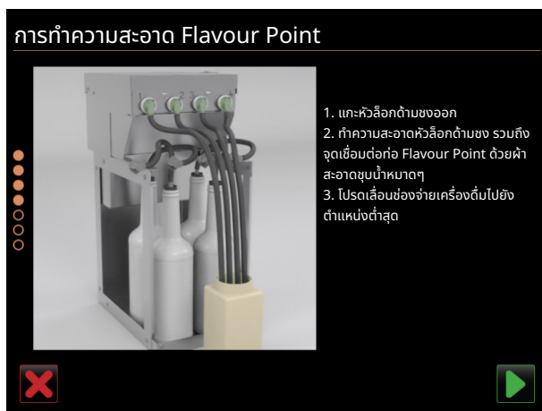
รูป 182: การต่อภาชนะทำความสะอาดเข้ากับ Flavour Point
