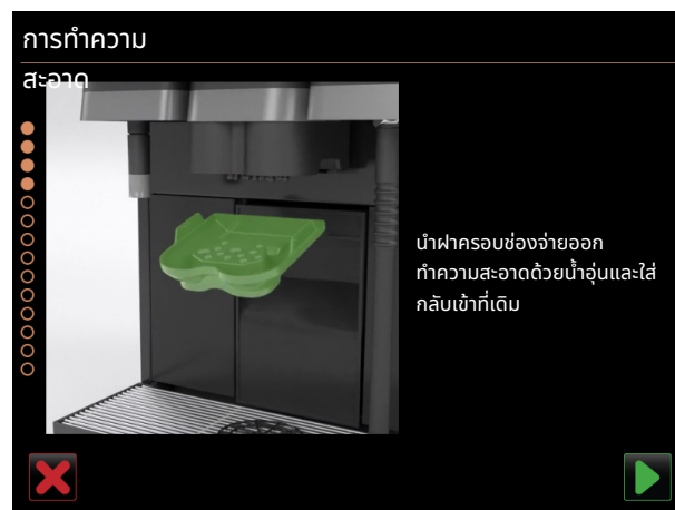
รูป 141: การนำฝาครอบช่องจ่ายเครื่องดื่มออก
