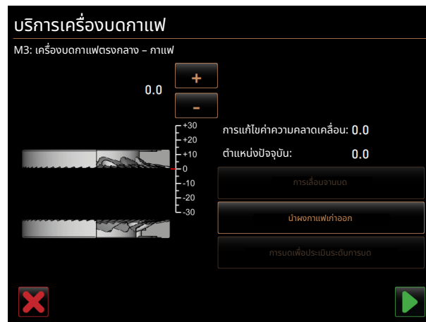
รูป 276: การตั้งค่าระดับการบด: การนำผงกาแฟทำออก
