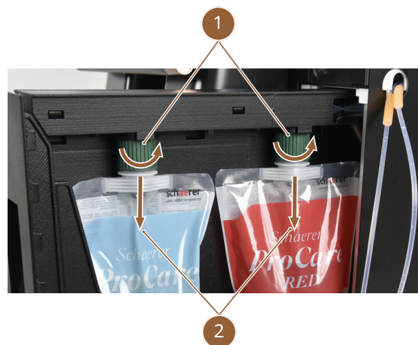
รูป 65: การนำถุงทำความสะอาดออก
