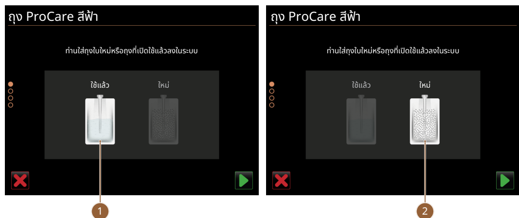
รูป 67: ตัวอย่างถุง ProCare สีฟ้า: การเปลี่ยนถุงทำความสะอาด
