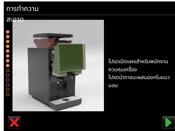
รูป 163: การยกแผงควบคุม
