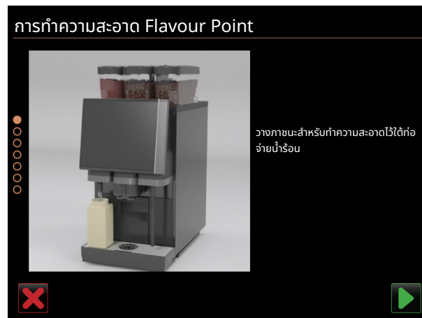
รูป 179: กล้องโต้ตอบวางภาชนะทำความสะอาดไว้ใต้ท่อจ่ายน้ำร้อน
