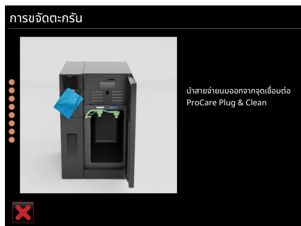
รูป 253: การนำสายจ่ายนมออกจาก Plug & Clean
