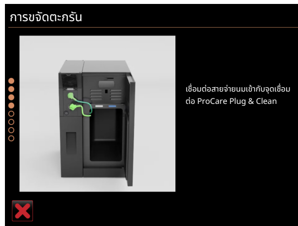
รูป 251: การเชื่อมต่อสายจ่ายนมเข้ากับ Plug &amp; Clean
