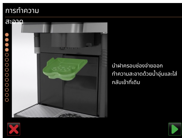
รูป 162: การนำฝาครอบช่องจ่ายเครื่องดื่มออก
